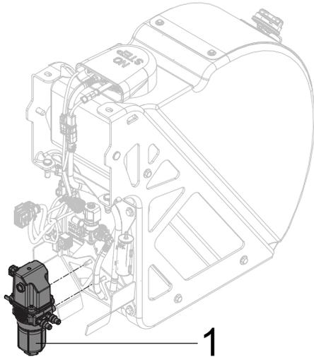
Illustration 5 : Pompe du liquide d'échappement diesel (DEF) avec l'ensemble du filtre
