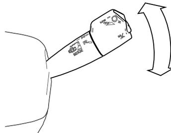
Le fait de déplacer le levier de vitesses vers le bas (dans le sens horaire) engagera le frein moteur, avec chaque position vers le bas fournissant davantage de freinage moteur. La position la plus basse (position 4) est une position momentanée et active le mode MAX.
