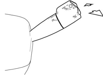
Le rapport de transmission peut être sélectionné manuellement pour répondre aux besoins de conduite du conducteur. Le mode de transmission doit être en marche avant ou en marche arrière pour sélectionner manuellement le rapport. En mode automatique
