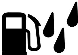
Si la notificación WIF está presente, drene manualmente el agua en el filtro de combustible primario montado en el motor lo antes posible. No drenar el agua y
